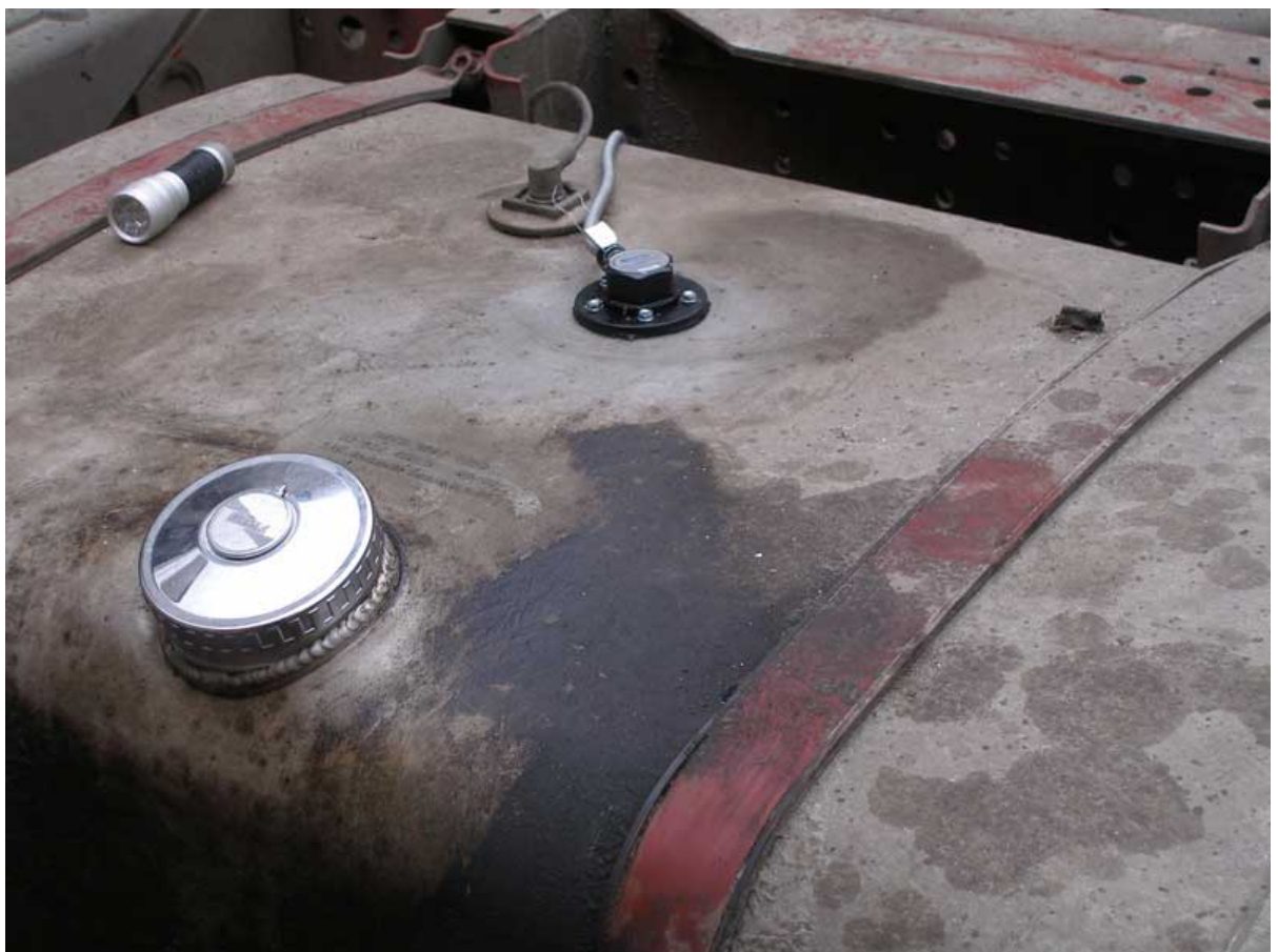
Установленные на два бака датчики уровня топлива
