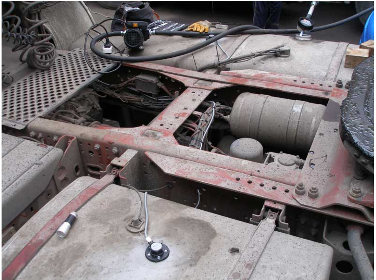
Установленные на два бака датчики уровня топлива
